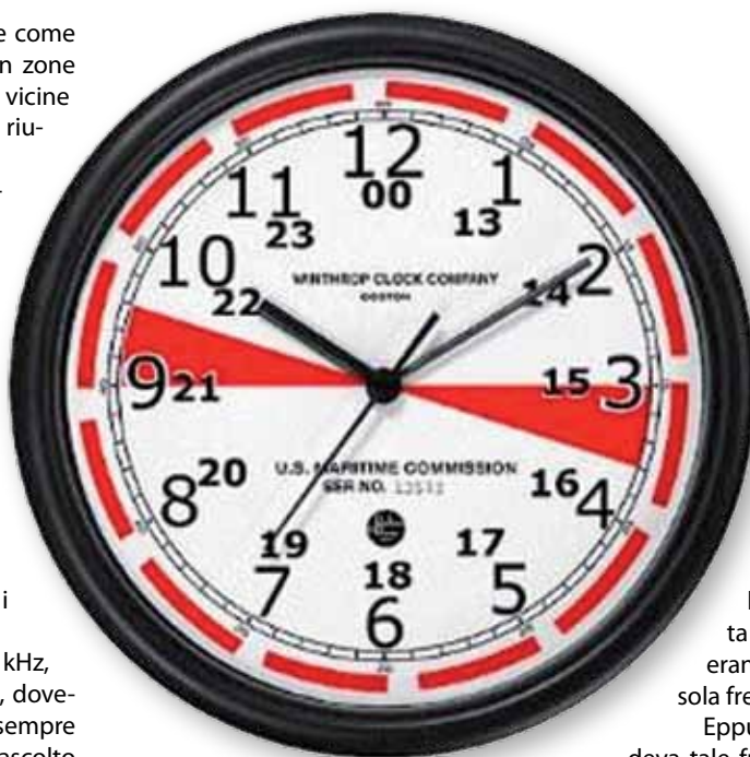
Orologio di una stazione radio di bordo con i settori dei periodi di silenzio marcati in rosso.
