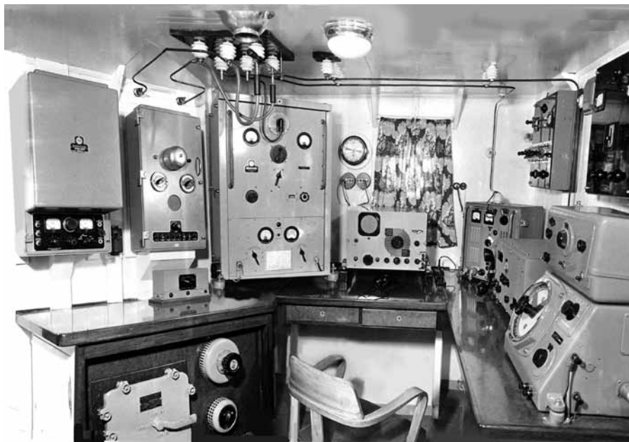
S/s Karalis. Rimorchiatore italiano d'alto mare per salvataggio e recupero relitti. Anni '50. SRT. Da sx. Sotto: reostato d'avviamento gruppo 4M. Sopra: A/A Marconi con suoneria tipo "Vedetta"; manipolatore automatico AT3 (sul banco); Tx Marconi T100 OM; Rx Marconi R781 OL-OM-OC; Tx emergenza Marconi T40-SM; Rx IRME "Aldebaran" MF; RDG Marconi 3/3 con antenna a loop incrociati a telaio fisso. Antenna RTx treccia rame monofilare a "T" da albero ad albero.
