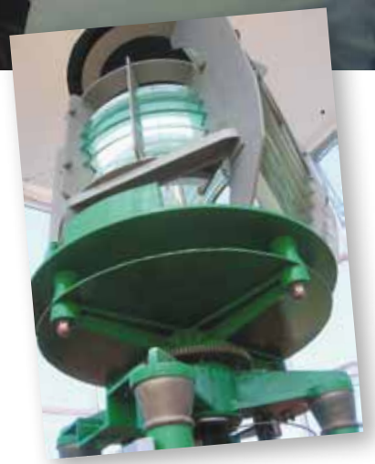
La "lanterna" del faro.
