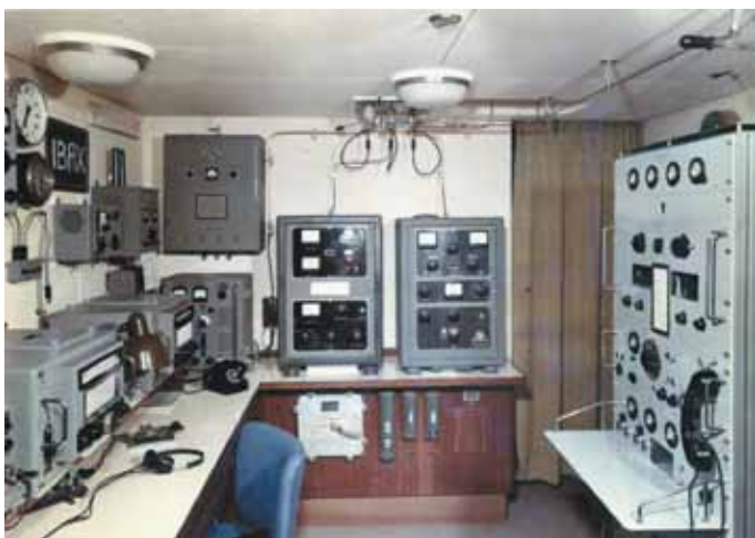
M/n Ausonia/IBAX. SRT. Da sx: 2 Rx Marconi R1241 OM e 1331 OC; Tx emergenza T40SM (sopra A/A INCAR IR150); T300 OM; T300 OC. A dx: Consolle IRME RTF MF/OC a doppia banda laterale (A3) tipo "Orione". Anni '50/60.
